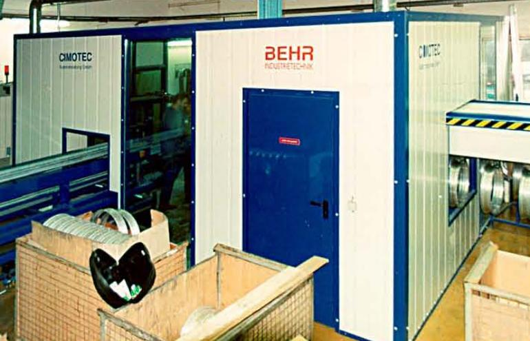
Die **schwere nachträgliche Volleinhausung** ist als stabile Stahlbaukonstruktion ausgeführt und bieten klare Vorteile im Hinblick auf **Anlagensicherheit sowie Lärm- und Emissionsschutz**. Sie erfüllen die neueste Arbeitsstättenverordnung in vollem Umfang. Sollte es die Bearbeitung erfordern, so ist die schwere nachträgliche Volleinhausung in einer **Explosions-Schutz-Ausführung** gemäß der **ATEX Richtlinien** lieferbar.
