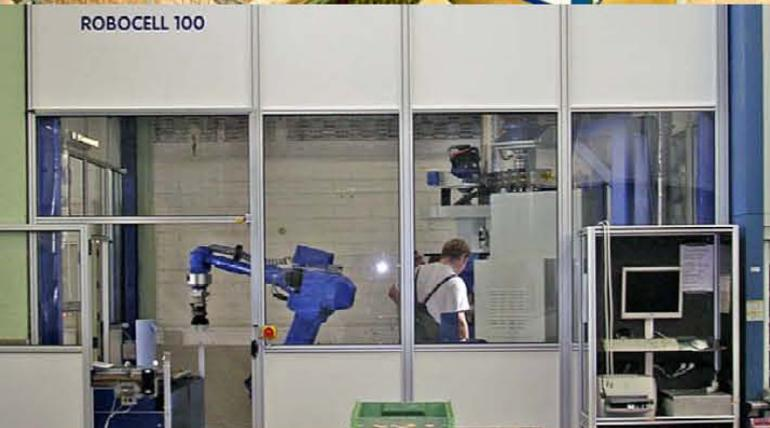
Die **leichte nachträgliche Volleinhausung** ist als Aluminium-Profilkonstruktion ausgeführt. Sie ist eine preiswertere Alternative zur schwereren Variante, die jedoch von Haus aus in **Explosions-Schutz-Ausführung** gemäß der **ATEX Richtlinien** konstruiert worden ist.
