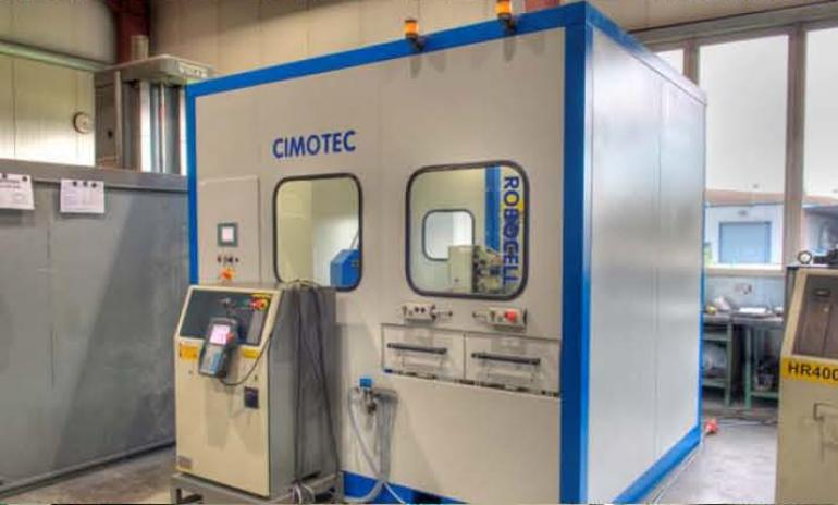
Die neue, leichtere **Volleinhausung mit integrierter Stahlbau-Bodenplatte** stellt eine sinnvolle Alternative zwischen Nutzen und Kosten dar. Bei vergleichbarer **Anlagentransportabilität** wie unsere großen ROBOCELL-Volleinhausungen bieten Sie eine interessante Alternative hinsichtlich der Anschaffungskosten. Diese Art der Einhausung ist derzeit nur in einteiliger Bauweise lieferbar.
